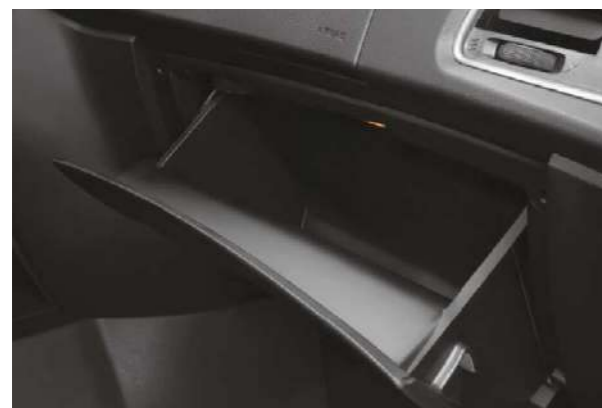
Охлаждаемый перчаточный ящик с разъемом USB
